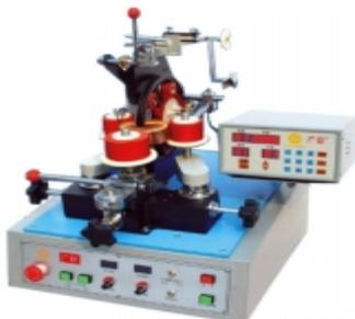
Las máquinas con cabezal deslizante cuentan con transbordadores de espacio libre de alta calidad, fáciles de operar, con deslizadores pulidos, suaves con aislamiento de alambre. Las lanzaderas se pueden cambiar en minutos para una máxima flexibilidad
