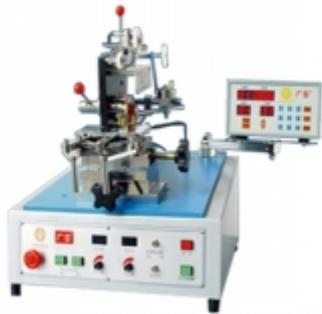
La serie KGC son máquinas rápidas, eficaces, de tamaño medio, para la producción en serie de pequeños componentes inductivos. Las máquinas de bobinar toroidales utilizan cabezales deslizantes y cabezas de correa para acomodar una amplia gama de tamaños de núcleo y diámetros de hilos. El accionamiento principal y la rotación del núcleo se logran con potentes motores de CA de larga duración y controladores de velocidad variable.
