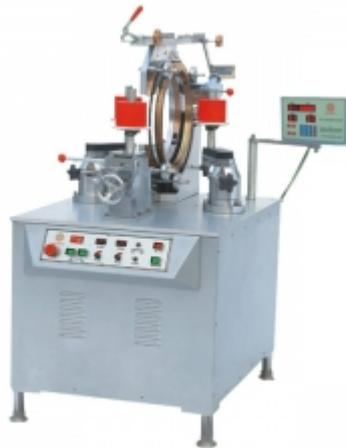
Las máquinas con cabezal cremallera son de construcción sólida, capaces de enrollar cables ligeros y pesados sin dañar el aislamiento. El estante de engranaje de espacio abierto y el cargador de espacio con bisagras facilitan el cambio de núcleo, maximizando la salida. Los almacenes fácilmente intercambiables garantizan máxima flexibilidad. Motores de CA extremadamente potentes y sin mantenimiento para el accionamiento principal y la rotación del núcleo.
